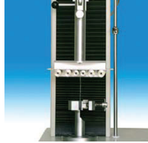
Dispositivo per prove di scollaggio a 90°.
