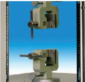
Morsetti Grabb test con chiusura a vite per prove di trazione su: tessuti, ecc.
