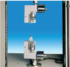
Morsetti pneumatici per prove di trazione su: filati, cordonetti, ecc.
