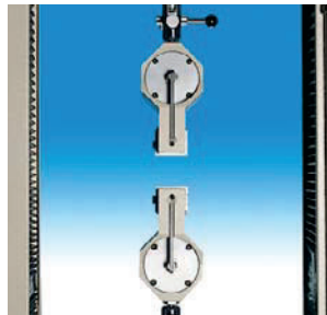
Morsetti pneumatici per prove di trazione su: tessuti, finte pelli, pelli, ecc.
