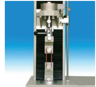
Morsetti per prove di trazione su matassine (lea test).
