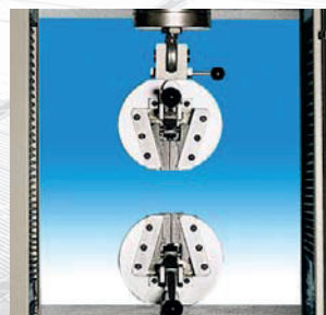
Morsetti autostringenti prove di trazione su: metalli, materie plastiche, legno, ecc.
