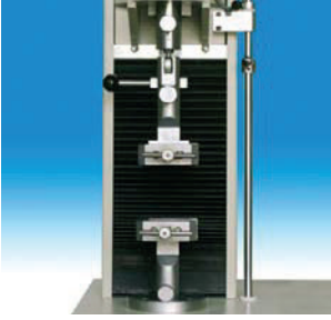
Morsetti con chiusura a vite per: trazione-lacerazione su: carta, film plastici, accoppiati.
