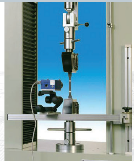
Estensimetro senza contatto (con videocamera) su una distanza di 20 - 25 - 50 - 75 - 100 mm.
