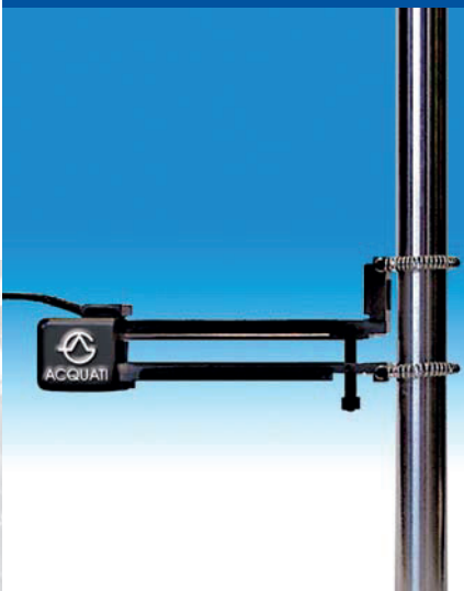
Estensimetro per prove su: acciai, materie plastiche, ecc. con corsa di 5 mm su una distanza di 25 - 50 mm.
