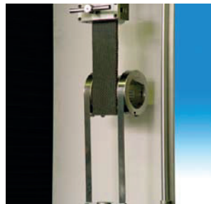
Dispositivo per prove di delaminazione su: materiale compositi (sandwich peel).
