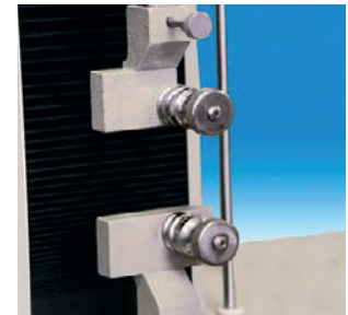
Morsetti per prove di trazione su: tubetti, ecc.
