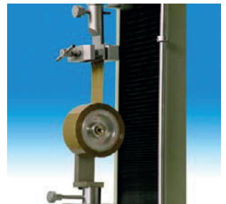
Dispositivo per prove di adesione su: nastri adesivi (adhesion peel).
