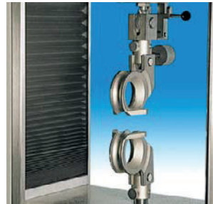
Morsetti per prove di trazione su corde.
