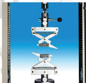
Morsetti autostringenti a leva per prove di trazione su: gomma, P.V.C., A.B.S., poliuretani, ecc.
