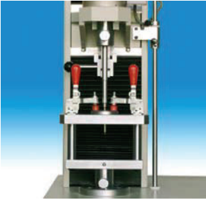
Dispositivo Persoz per prove su: carta, film plastici, accoppiati, tessuti, pelli, ecc.
