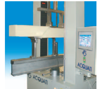
Dispositivo flessione a quattro punti e rottura al taglio su pannelli coibentati.
