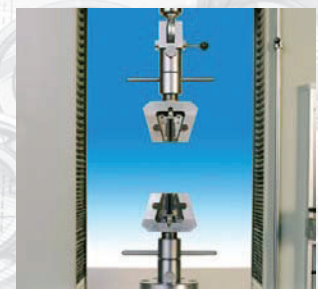
Morsetti autostringenti per prove di trazione su: metalli, materie plastiche, rinforzati in fibra di vetro, compositi, ecc.
