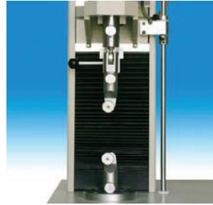
Morsetti per prove di trazione su: filati ecc.
