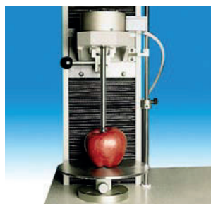
Dispositivo per prove di Magnes-Taylor per frutta, ecc.
