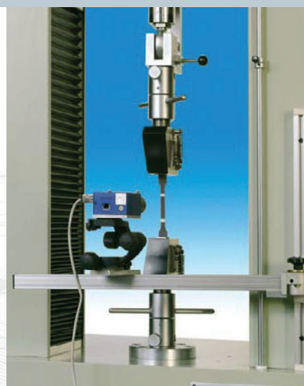
Estensimetro senza contatto (con videocamera) su una distanza di 20 - 25 - 50 - 75 - 100 mm.
