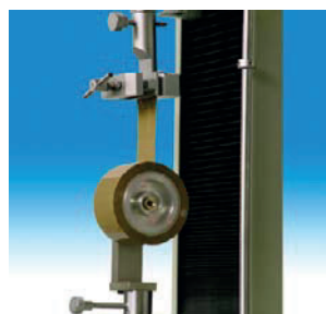
Dispositivo per prove di adesione su: nastri adesivi (adhesion peel).
