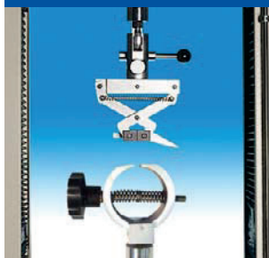
Coppia di morsetti per prove di stacco suola/tomaia.
