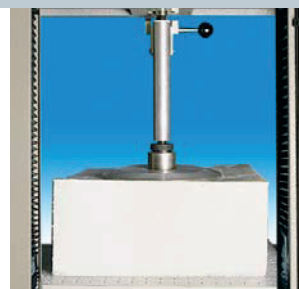
Dispositivo indentometro e per prove di portanza.
