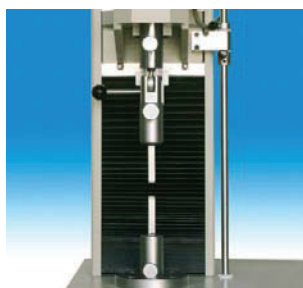
Dispositivo per prove di strappo su: pelli J.U.P.8.
