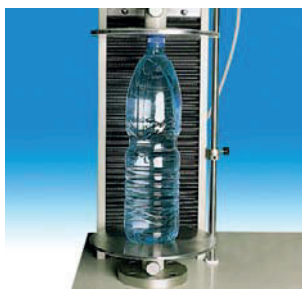
Coppia piatti per prove di: compressione su bottiglie, astucci, contenitori vuoti e pieni.
