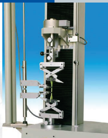
Estensimetro con corsa lunga (250 - 650 mm) su una distanza di 20 - 25 - 50 - 100 mm.
