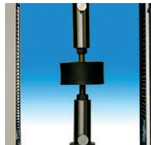
Dispositivo per prove di adesione compressione e su 4 quadranti, per antivibranti
